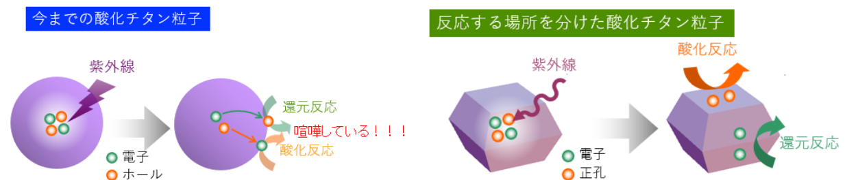
一般の光触媒粒子（左）と反応サイトが分離されて、電子と正孔が反応する場所が異なる光触媒粒子（右）の反応の模式図
